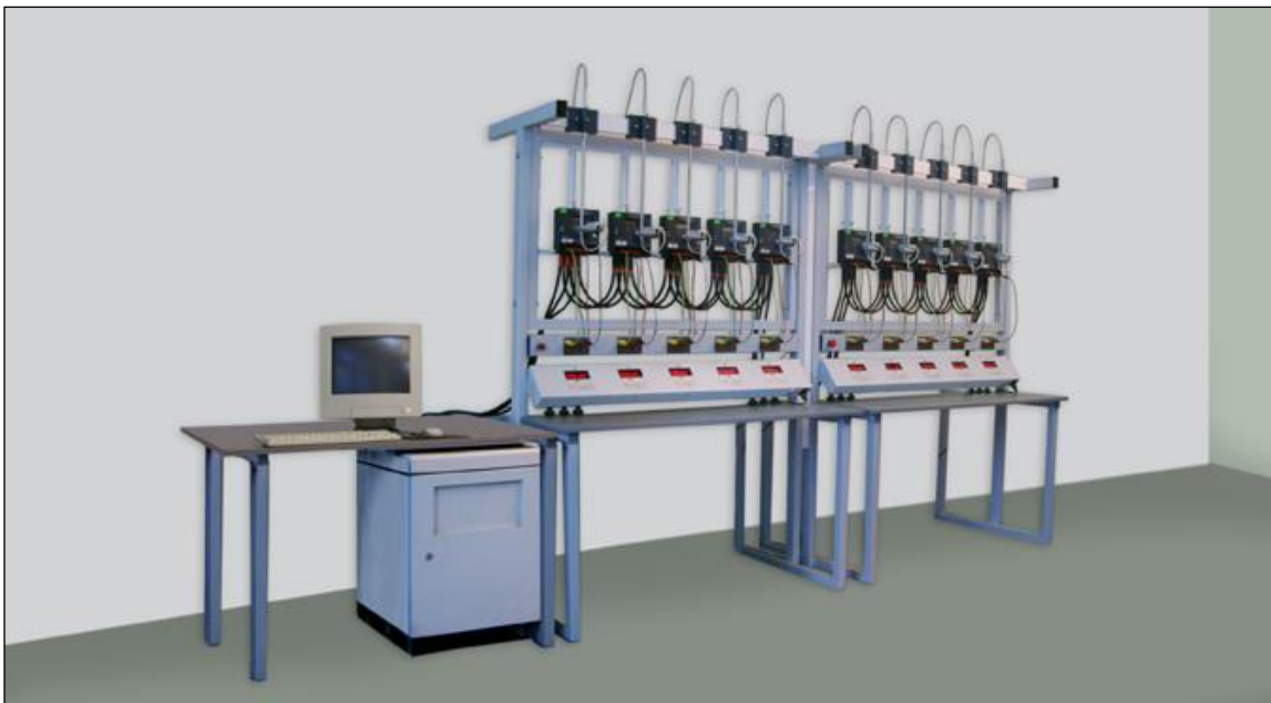
Стенд за проверка на 10 броя трифазни електромери
